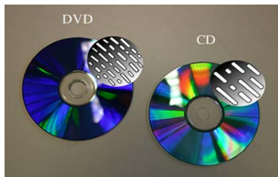
Figura I.21: Diferencias en el tamaño de pits y lands entre DVD's y CD's.
